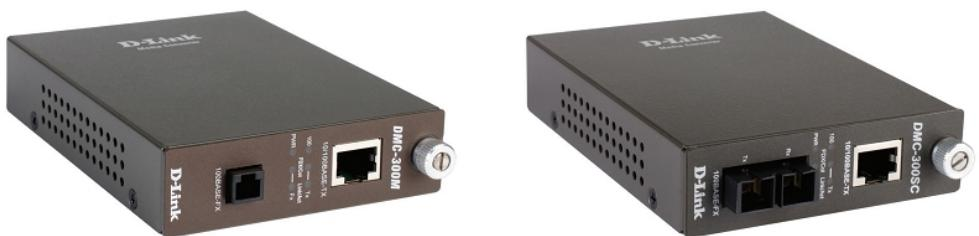
Эти медиаконвертеры преобразуют сигнал из стандарта 10BASE-T/100BASE-TX Fast Ethernet на витой паре в сигнал стандарта 100BASE-FX Fast Ethernet по многомодовому оптическому кабелю. Максимальная длина оптического кабеля: 2 км. Устройство оснащено 1 портом RJ-45 для витой пары и 1 оптическим портом.
