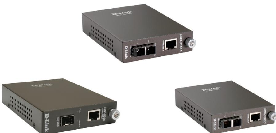
Медиаконвертер DMC-700SC: преобразует сигнал из стандарта 1000BASE-T Gigabit Ethernet на витой паре в сигнал стандарта 1000BASE-SX Gigabit Ethernet по многомодовому оптическому кабелю. Максимальная длина оптического кабеля: 550 м. Устройство оснащено 1 портом RJ-45 для витой пары и 1 оптическим портом с разъемом SC.
