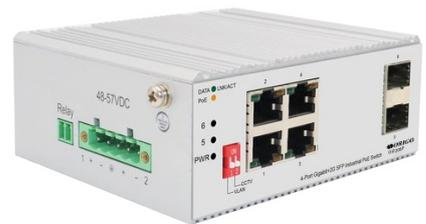
Коммутатор поддерживает стандарты 802.3af/at PoE с возможностью подачи питания до 30 Вт на порт при общем PoE-бюджете 60 Вт. Для систем видеонаблюдения реализованы режимы VLAN и CCTV, позволяющие изолировать трафик PoE-портов и увеличить дальность передачи данных и питания до 250 м.
