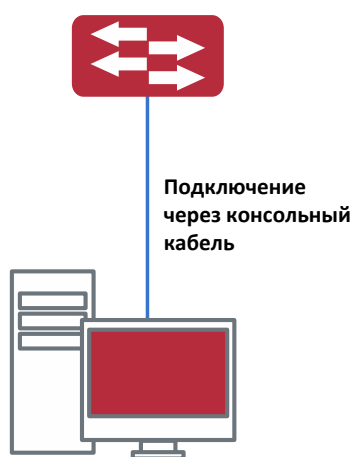
Рисунок 1. Подключение ПК к консольному порту коммутатора
