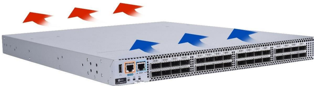
Рисунок 5. Тепловыделение и вентиляция QSW-6900-32H
