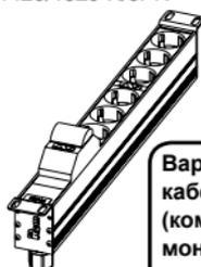
Варианты монтажа кабельного ввода (комплектующие для монтажа входят в комплект поставки).
