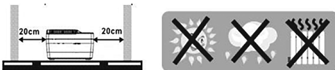
Figure 1. Posizionamento dell' UPS
