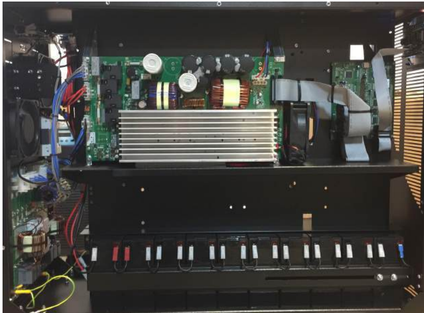
Рисунок 11. Расположение батарей 7Ач,9Ач SOLOMMB 14 кВА
