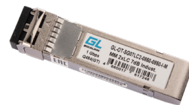
GL-OT-SG07LC2-0850-0850-I-M Промышленный SFP, 1 Гбит/с, два волокна MM, 2xLC, 850 нм, 7 дБ, до 500 м
