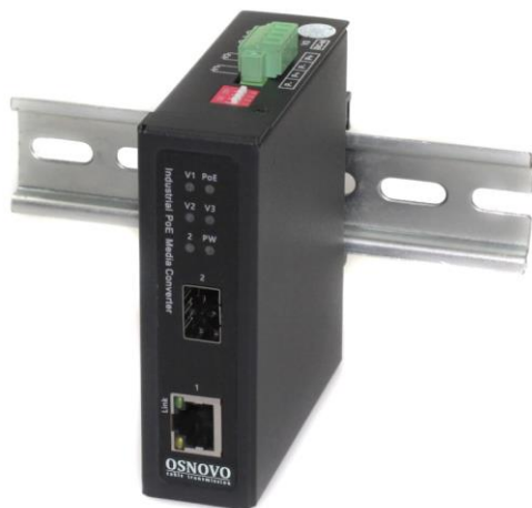
Рис.1 Медиаконвертеры OMC-1000-11X/I, OMC-1000-11HX/I, OMC-1000-11BX-I, общий вид
